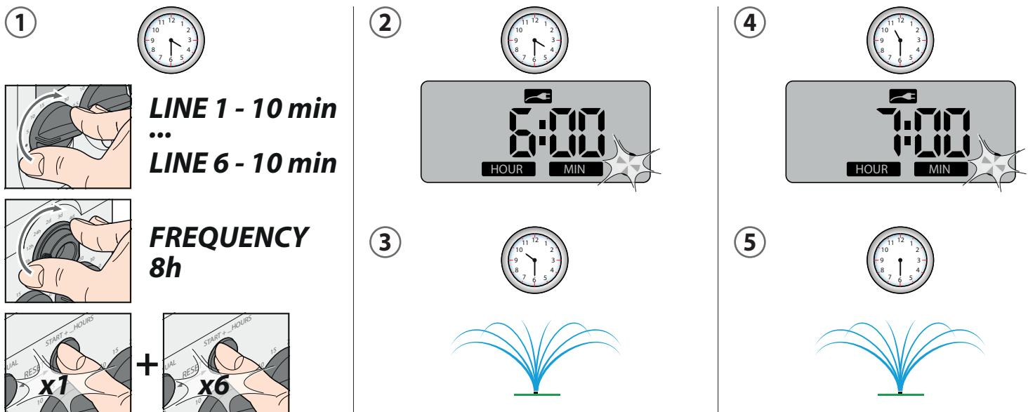
**IT PROGRAMMAZIONE - Modificare un programma.** Per modificare un programma di irrigazione in esecuzione, cambiare le impostazioni del selettori LINE e FREQUENCY come desiderato. Esempi:
