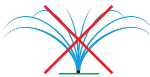
**IT RESET.** La funzione RESET chiude la valvola, se aperta, e spegne il programmatore. L'irrigazione sarà interrotta fino ad un nuovo comando di START+..., oppure di TEST. L'orario viene annullato, mentre durata e frequenza rimangono invariati. Per modificarli, agire manualmente sulle singole manopole. Per effettuare il RESET premere contemporaneamente i pulsanti TEST e START+... per 10 secondi. Sul display compare la scritta OFF.
