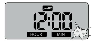
**IT STOP.** La funzione STOP (pressione contemporanea di TEST e START+... per 1 secondo) interrompe l'esecuzione di un ciclo di irrigazione in corso. L'irrigazione riparte regolarmente con il ciclo successivo in base alla frequenza impostata. La funzione STOP consente inoltre di anticipare la chiusura della valvola attivata in modalità TEST.
